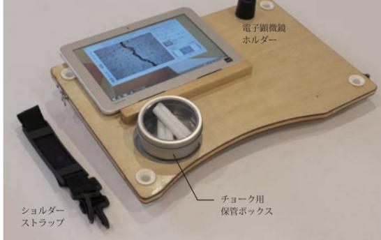
※現場での点検作業にタブレット、野帳、チョークに電子顕微鏡ホルダーが付いています。
